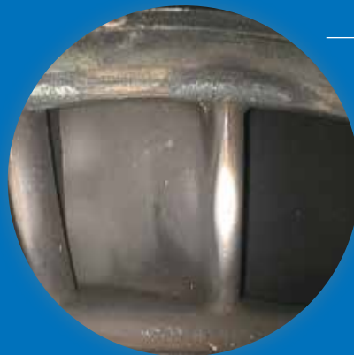
Fissuras no bico de uma turbina (Indústria Aeroespacial)
